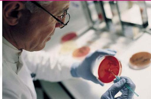
Se utilizan muestreadores de aire los cuales filtran un volumen determinado de aire. En el interior se colocan las placas Petri o Rodac y se pone en funcionamiento el muestreador durante un tiempo determinado. Esta técnica es cuantitativa ya que expresa su resultado en número más probable de microorganismos por volumen de aire.
