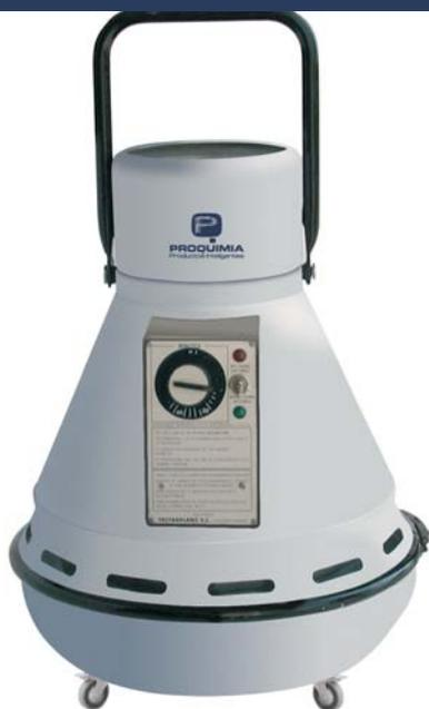
Equipo de micronebulización térmica que produce un aerosol seco. Tamaño de gota de tan sólo 0,2-0,8 micras con permanencia aérea de hasta 5 horas. El equipo nebulizador NEBUTEC trabaja con programación automática, y cuenta con una resistencia interior de 900 w que se encarga de suministrar el calor necesario para realizar la termonebulización. Este equipo se recomienda en volúmenes inferiores a 1000 m3 en instalaciones con alta densidad de maquinaria.
