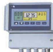
**Controladores serie B:** para pH y conductividad, con dos salidas de relé tipo On/Off, una salida de relé proporcional por tiempo, una salida 4-20mA para el control proporcional y otra salida 4-20mA para registro. Compensación manual de la temperatura.
