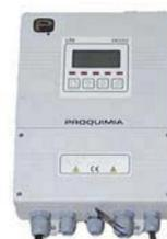
**Controladores serie MED y MPD:** para conductividad y pH respectivamente, con hasta 4 salidas de relé configurables y hasta dos salidas analógicas seleccionables 4-20mA ó 0-20mA. Compensación automática de temperatura por Pt100 ó Pt1000.
