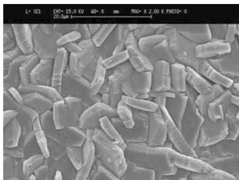
Fotografía S.E.M. x 2000, Capa Fosfato Microcristalino (Profos 305-M)
